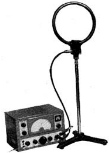
6・18 遮蔽ループ・アンテナを小型信号発生器に接続したところ
